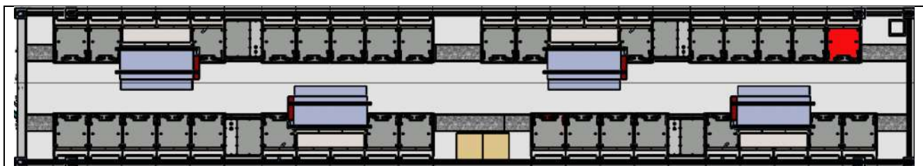
Figure 7 : Implantation des quatre ventilo-convecteurs au sein du container (en violet), les racks sont représentés (en gris) le rack de secours (rack spare) en rouge. (Source : plan Nidec)
