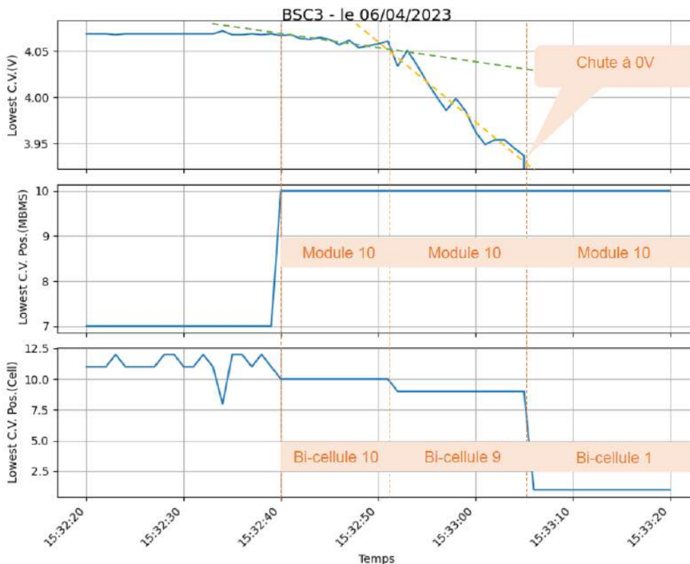
Graphique 8 : localisation de la bi-cellule concernée par une baisse anormale de tension
