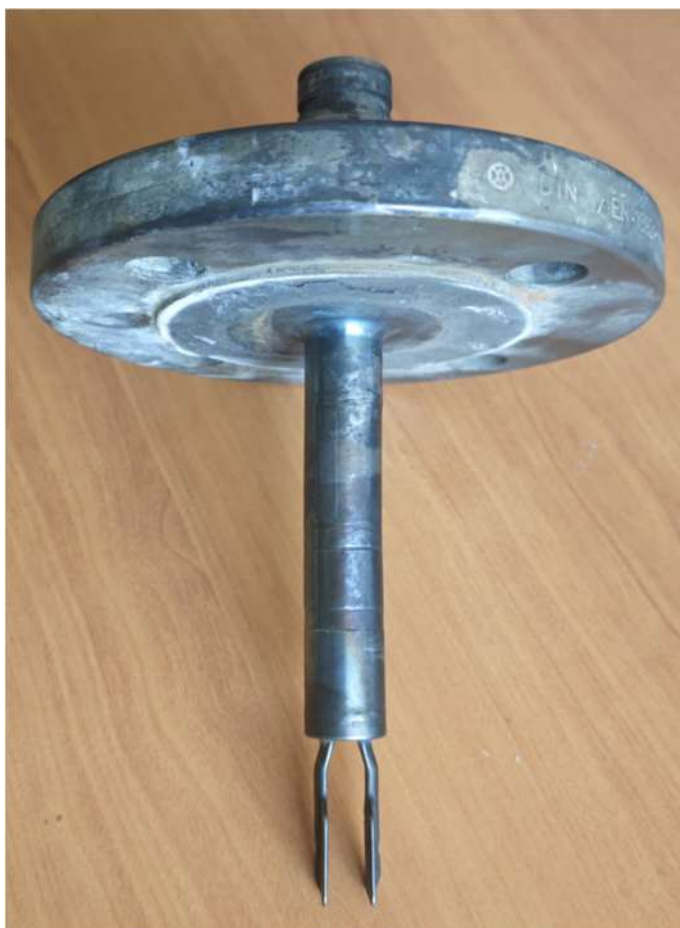
Photo 2 : Capteur de niveau installé sur le site de SAIPOL au moment de l'explosion
