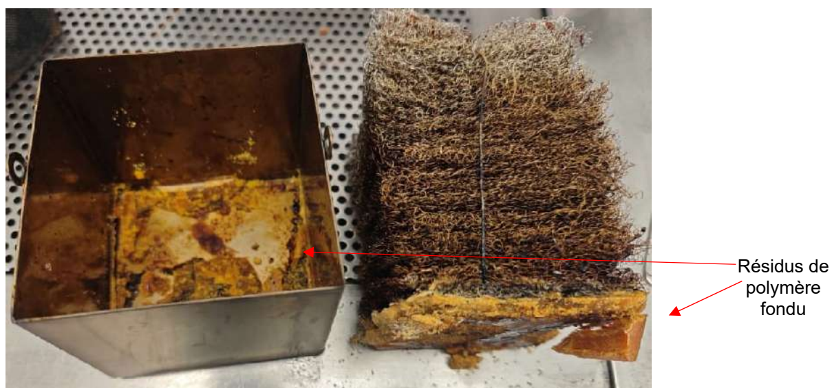
Figure 23 : Photos du média poreux/EMAG/méthanol après 3 jours en étuve à 160°C
