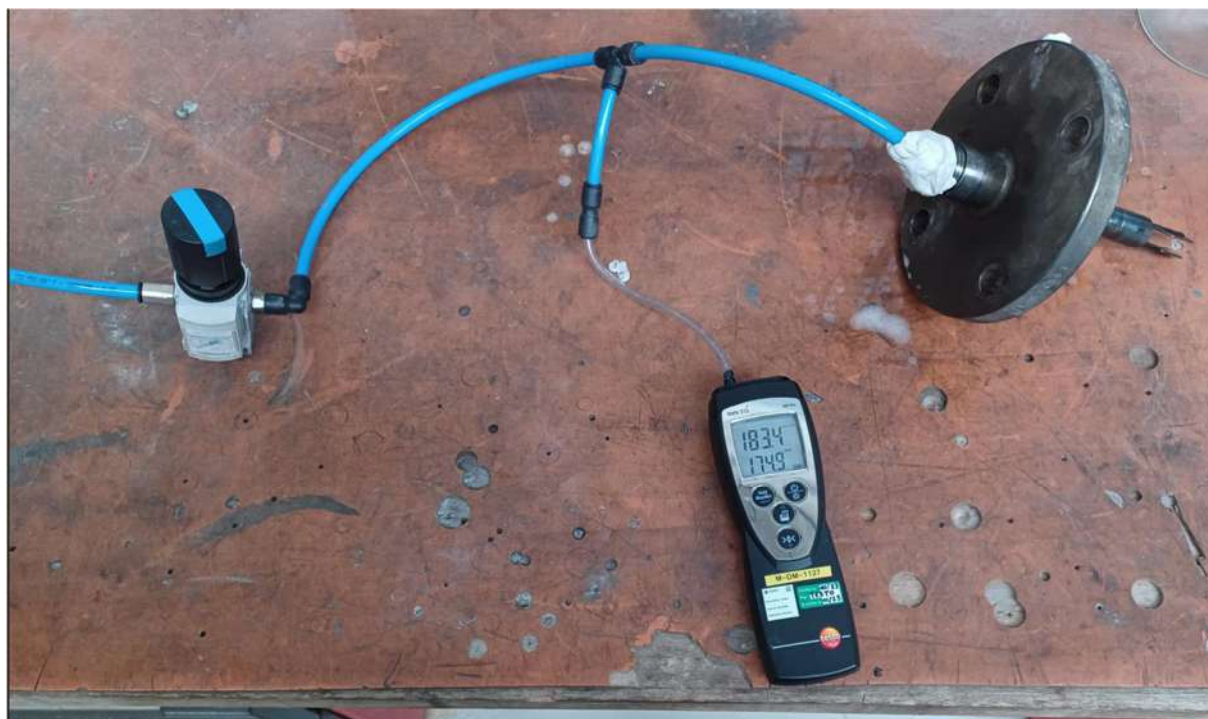
Photo 3 : Test d'étanchéité à l'air comprimé sur le tube prolongateur du capteur à bilame
