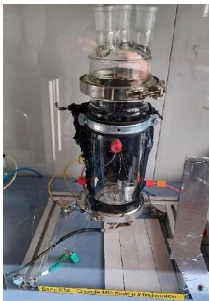
Figure 6 : Photo du dispositif d'essai de mesure d'EMI
