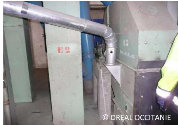
Aspiration de poussières sur un transporteur à bande et en tête d'un élévateur
