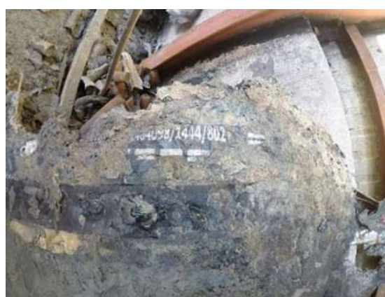
Photographie 15 : résidu du palox fondu et de sachet de protection sur les deux emplacements des caisses phyto et PNC
