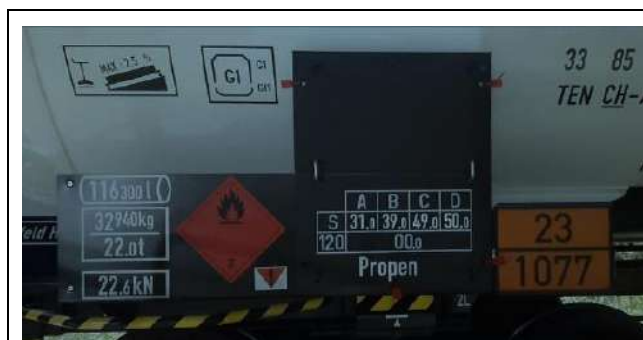
Figure 10 : Photo du wagon-citerne de propylène partiellement dépoté (Crédit : LAT NITROGEN)
