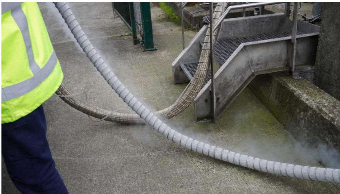
Figure 14 : Givrage du flexible de dégazage avec panache de condensation (sur site témoin)
