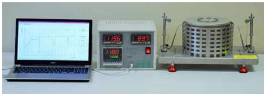
Figure 2 : Dispositif expérimental de détermination la température minimale d'inflammation en couche de 5 mm selon la norme ISO/IEC 80079-20-2
