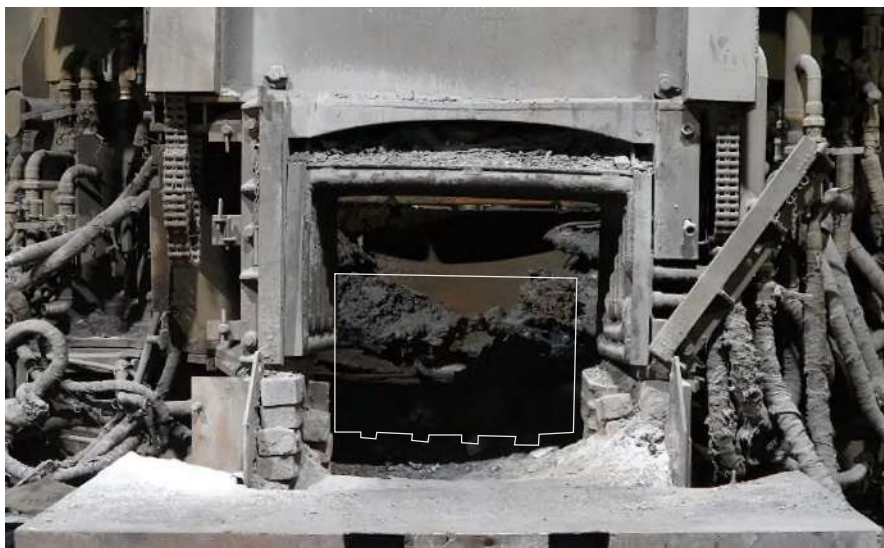
Photographie 13 : vue depuis l'extérieur du four de la porte des laitiers par laquelle passe la tête du béliet.
