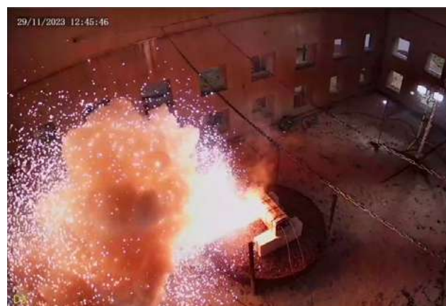
Déclenchement d'un emballement thermique sur un module de batterie électrique au moyen d'un PAD chauffant - Highway Logistics France
