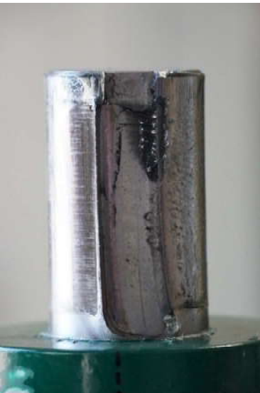
Photographie 9 : déformation au niveau de la rainure de clavette de transmission
