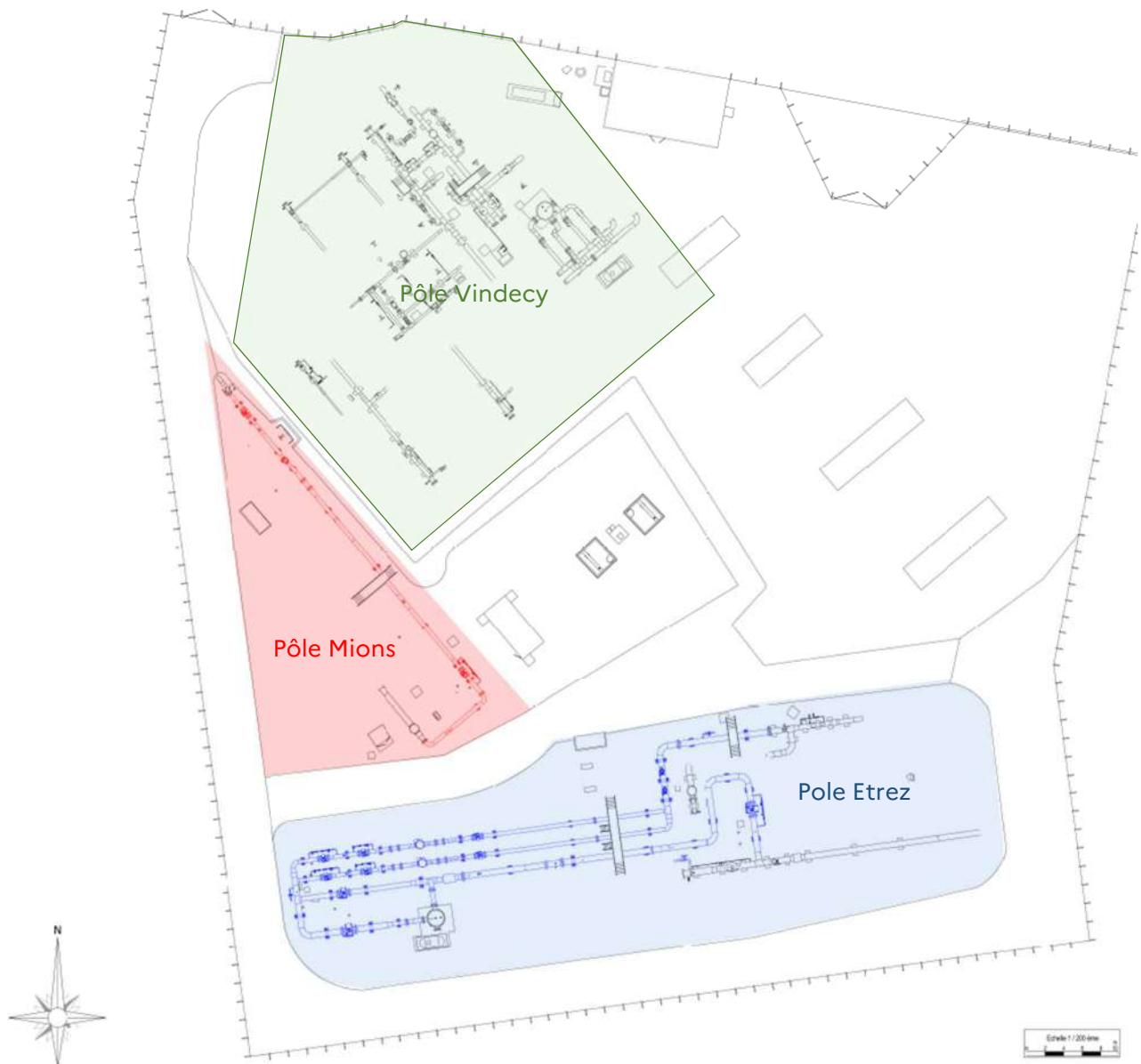
Figure 1 : Plan de l'installation d'Ars-sur-Formans et localisation des secteurs Les secteurs remis à neuf en 2020 et 2021 sont les pôles de Mions et Etrez (crédit GRTgaz)
