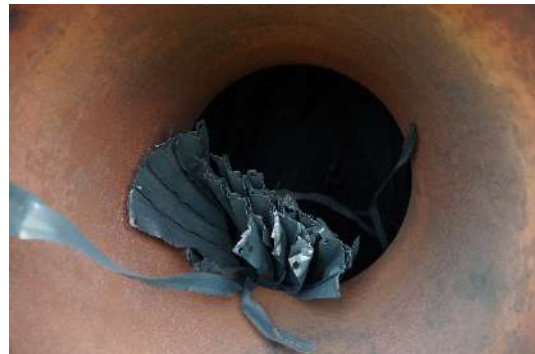
Figure 13 : Photos du filtre. En haut vue extérieure, en bas à gauche intérieur de la partie basse, vue à travers la canalisation d'entrée ; en bas à droite intérieur de la partie haute, vue de la canalisation de sortie
