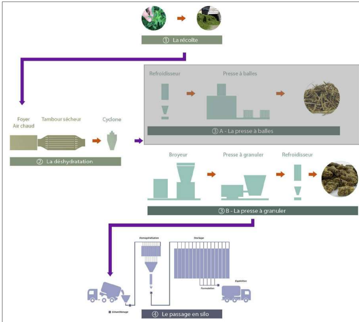
Figure 3 : illustration des étapes de fabrication des granulés de luzerne (source : site Internet Desialis).
