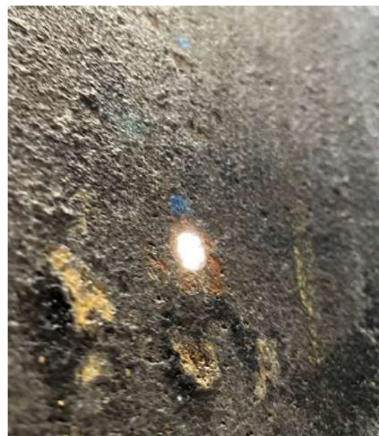
Figure 11 : surface interne du tube
