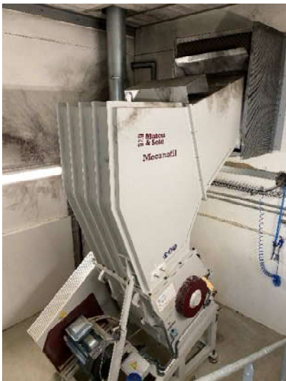
Figures 2 et 3 : photos du broyeur et de la trappe d'introduction des rebuts dans le broyeur
