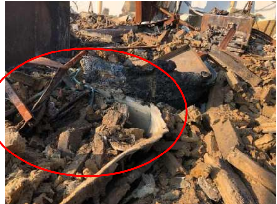
Photo 17 : Le point d'origine du sinistre. On peut apercevoir le bac qui contenait le bain en bas à gauche de la photo.
