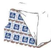
Stockage et protection des sacs palettisés.
