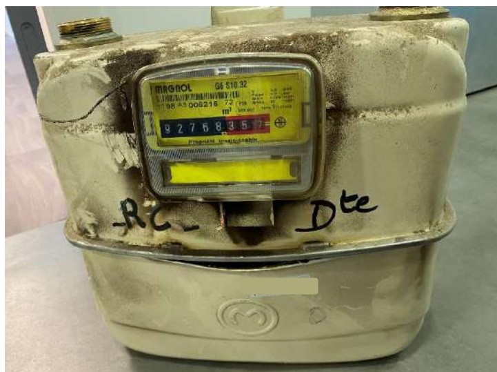
Figure n°1 : compteur ayant subi la surpression
