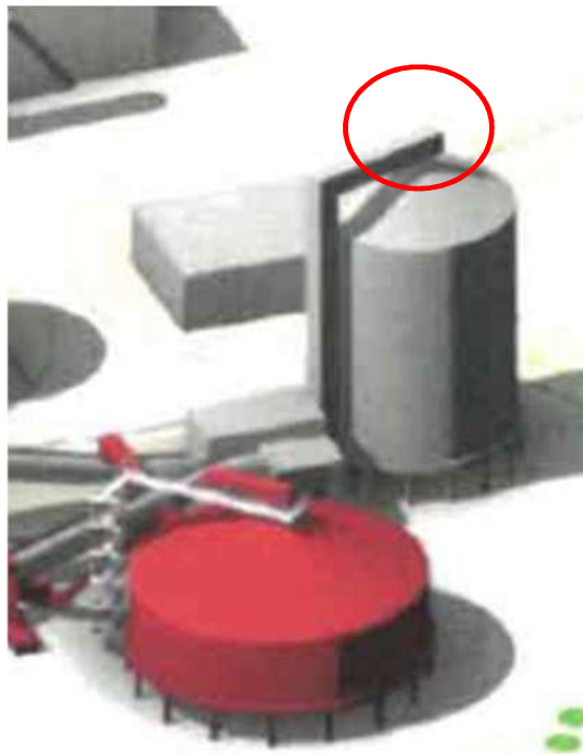
Figure 8 : Localisation de l'endroit où les premiers opérateurs ont aperçu des braises sortir du capotage de la bande à bords
