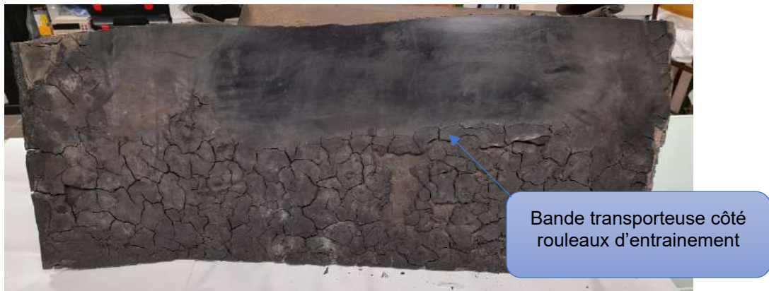
Figure 3 : Bande transporteuse, vue arrière côté rouleaux d'entraînement
