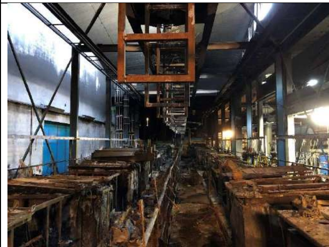
Photo 17 : Vue des lignes et des baigns d'acide et de leurs couvercles
