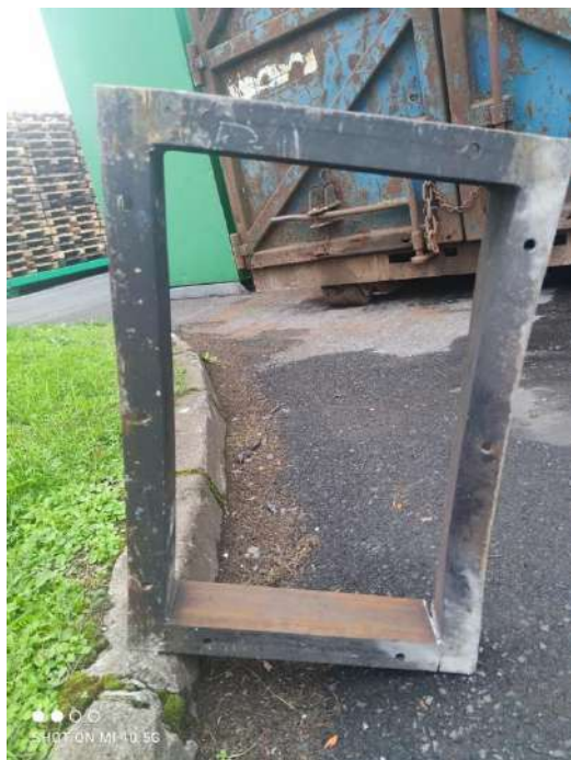
Photographies 2 et 3 : Photographies du cadre pré-percé en atelier. Les trous réalisés ne correspondent pas au plan de montage prévu par le schéma communiqué par l'exploitant.
