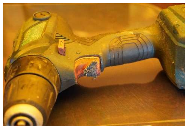
Photographie 5 : présence de matière textile sur la gâchette
