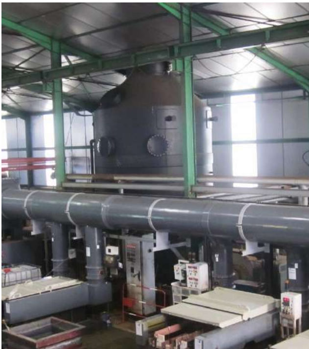
Photographie 6 : A Gauche une photographie de la tour de lavage (équipement de couleur noire au second plan) et du système d'aspiration des vapeurs (de couleur grise) A droite, une photo de l'emplacement de la tour de lavage après l'incendie sur laquelle on devine la base circulaire.
