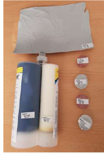
b. Cartouches de base, de durcisseur, échantillons de résine réticulée sous forme de plaque et de pastilles (non utilisées pour les essais)
