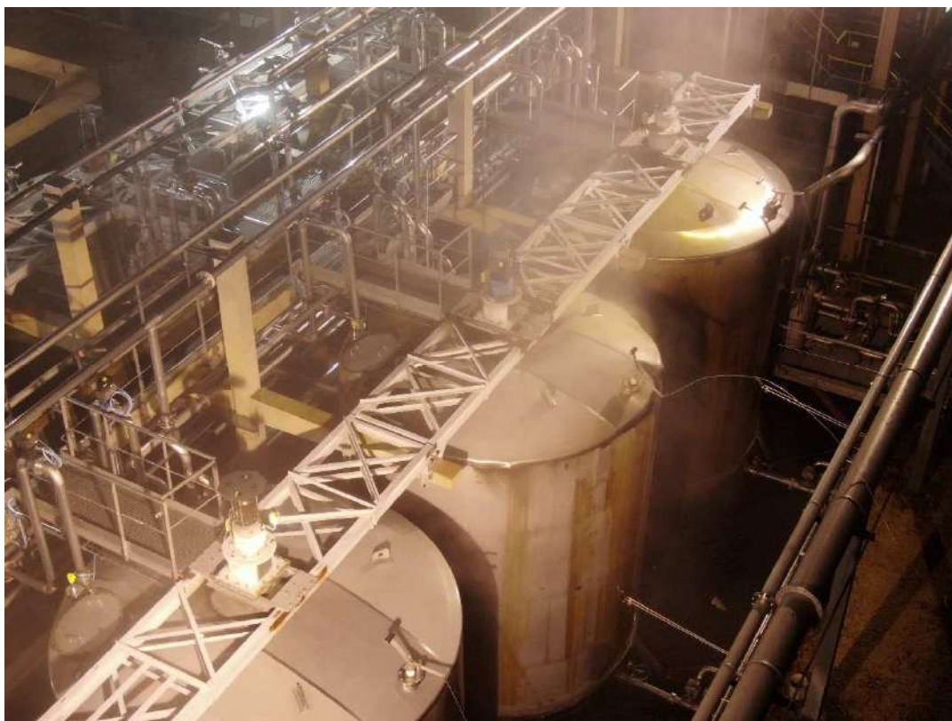
Photo 2 : Vue de la citerne R30 au centre après l'explosion et des agitateurs au-dessus (Source : SDIS24)
