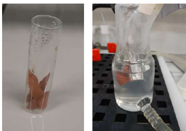
Figure 12. Exposition de la résine (placée dans un tube à essai à gauche) à la phase vapeur en réacteur verre (à droite)
