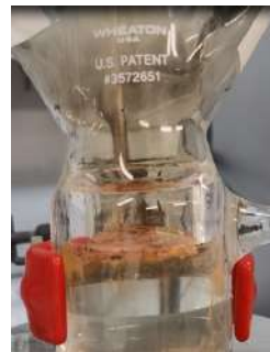
t = 13 min Dissolution progressive de la résine
