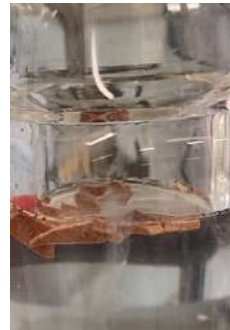
t = 1 min Bulles à la surface de la résine
