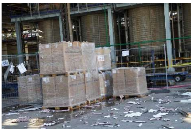
Photos 21 et 22 : Stockage de 2,6 t de nitrocellulose présent dans la zone d'explosion du bâtiment.
