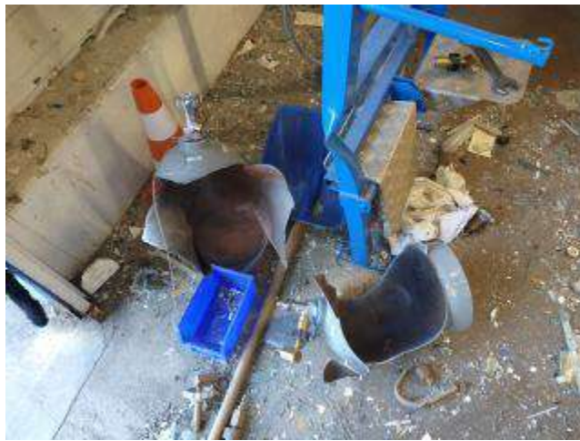
Figure 4 : Deux bouteilles éclatées
