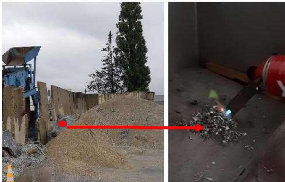
*Figure 9 Réactivité à la flamme des échantillons 21AR079*
